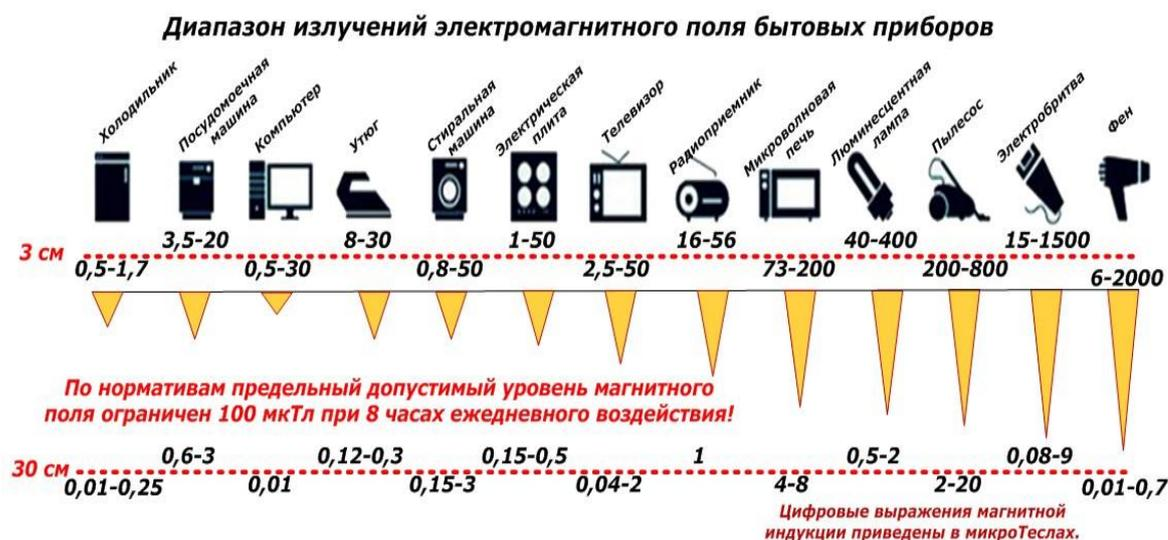
Рисунок 1 – Источники электромагнитного излучения [6]
