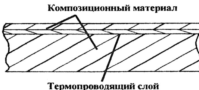
Рисунок 8 – Схема многослойного поглотителя [42]
