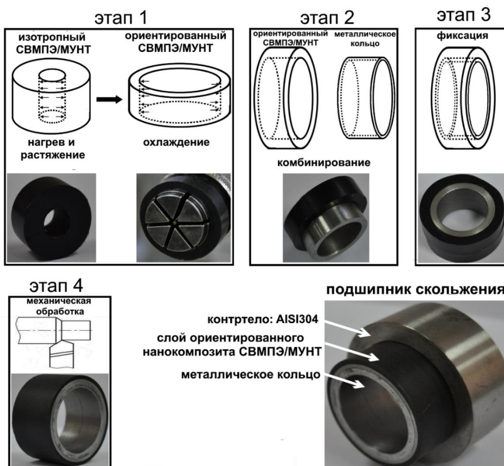
Рисунок 31– Схема изготовления металл-полимерных подшипников скольжения с использованием объемных ориентированных нанокompозитов
