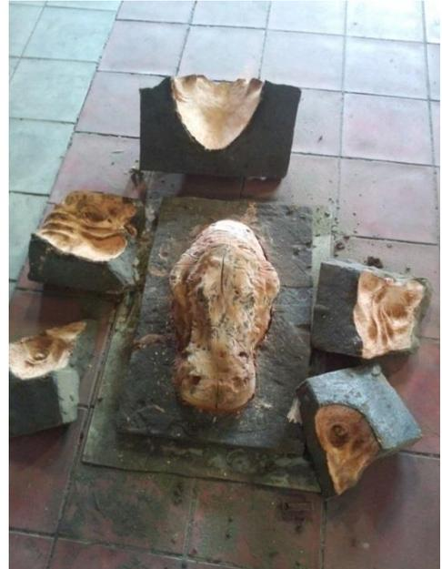
Рисунок 40 – Куски формы из ХТС с противопригарным покрытием
