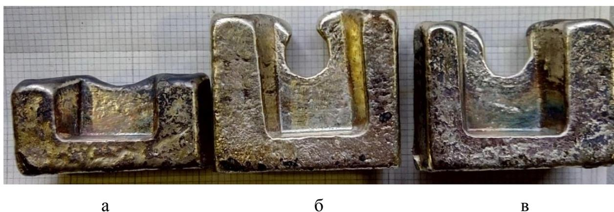
Рисунок 59 – Образцы проб на жидкотекучесть нейзильбера без примесей (а), с добавкой 0,5% Al (б) и с добавкой 0,2% Si (в), полученные по шариковой пробе
