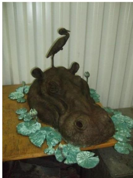
Рисунок 41 – Отливка «болотная идиллия», полученная литьем в кусковую форму из ХТС с облицовочным противопригарным покрытием
