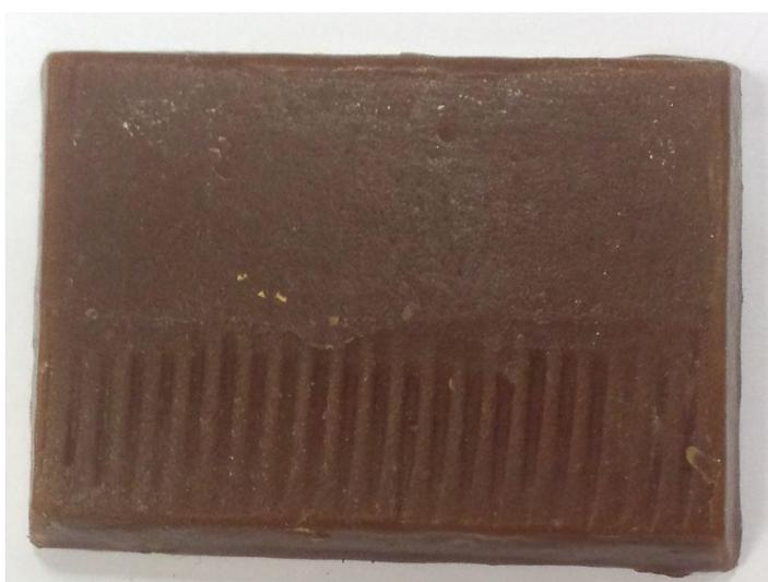
Рисунок 37 – Модель с разделительным составом № 1 (таб. №10) после снятия ХТС
