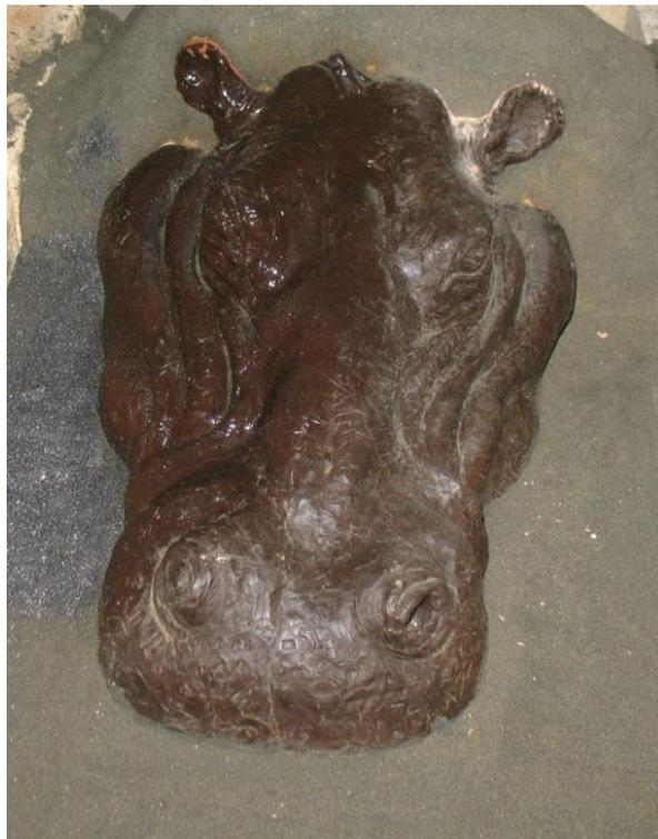
Рисунок 38 – Модель с нанесенным разделительным составом «Cramolin Silikon»
