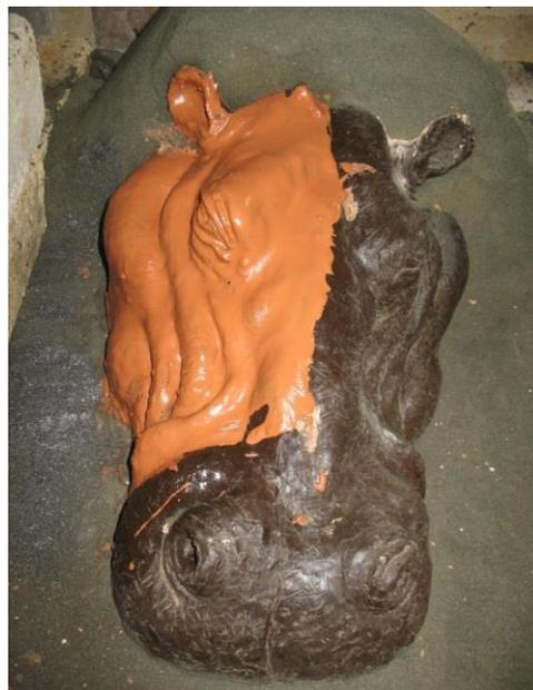
Рисунок 39 – Модель с нанесенным слоем суспензии
