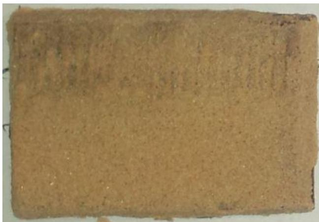
Рисунок 36 – Модель с разделительным составом № 4 (таб. №10) после снятия ХТС
