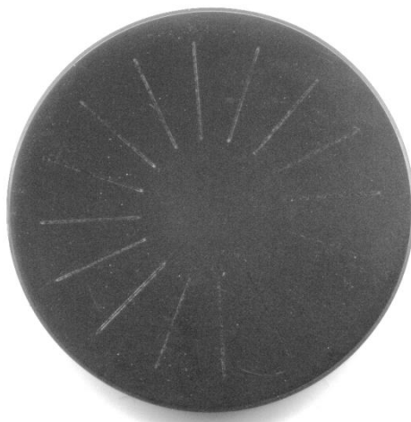
Рисунок 6-8 – Внешний вид образца покрытия Ti-C-Ca-P-O-N, осажденного на титановый диск диаметром 27 мм (СО КТ НМ № 02/1) после трибологических испытаний
