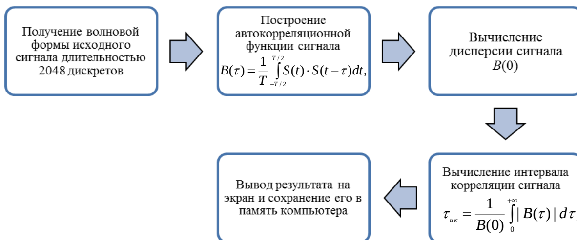
Рисунок 1 – Алгоритм обработки принимаемого шумового сигнала
