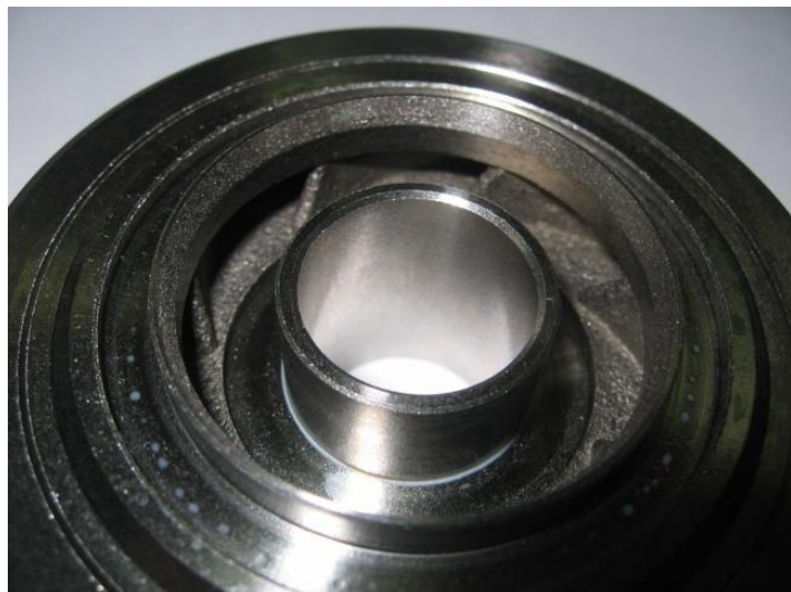
Рисунок 7 - Вид борированной отливки
