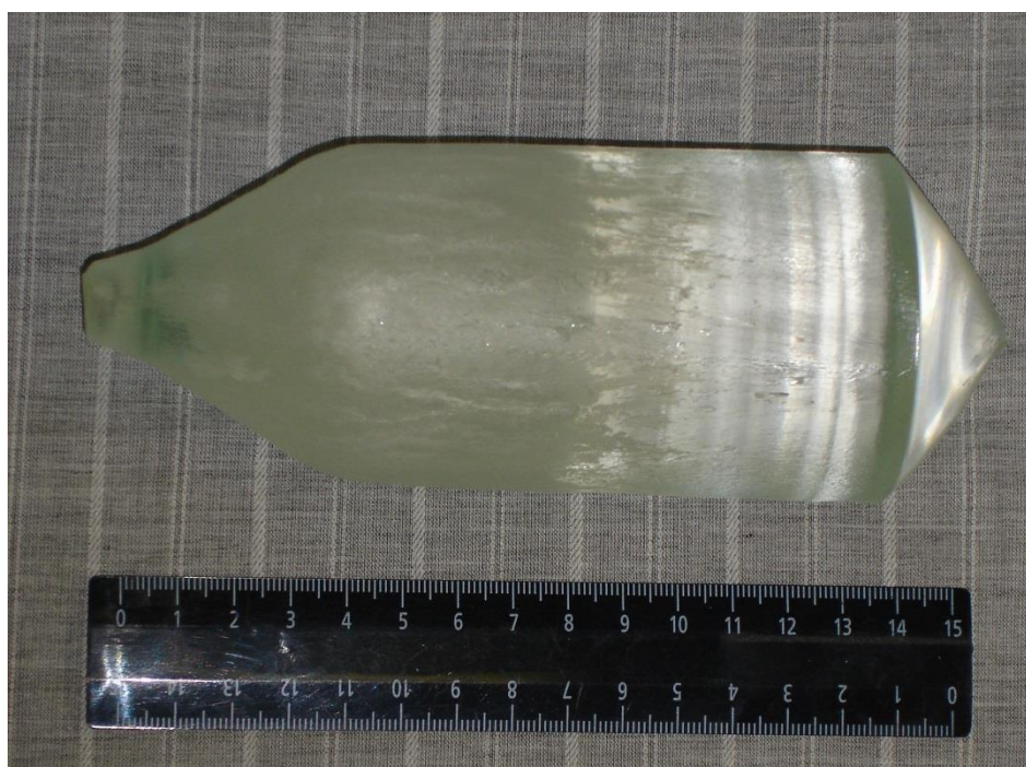
Рисунок 20 – Кристаллы лангатата, полученные в разных атмосферах: \text{Ar}+(2\%)\text{O}_2 (а), \text{Ar} (б)
