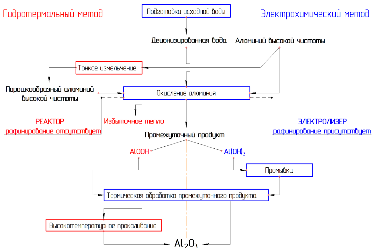
Рисунок 11 – Обобщенная технологическая схема получения оксида алюминия высокой чистоты
