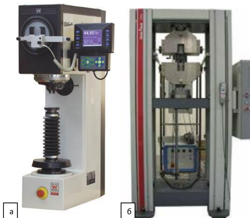
Рисунок 2.4. Оборудование для проведения механических испытаний: (а) универсальный стационарный твердомер Wilson Wolpert 930 M, (б) универсальная испытательная машина ZwickZ250
