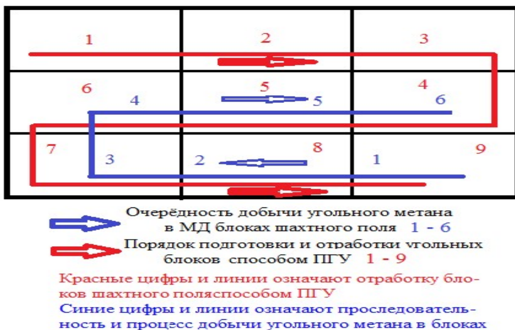
Рисунок 4.2 - Неравномерно – распределённая схема размещения газифицируемых (красный цвет) и метанодобывающих (синий цвет) блоков на шахтном поле
