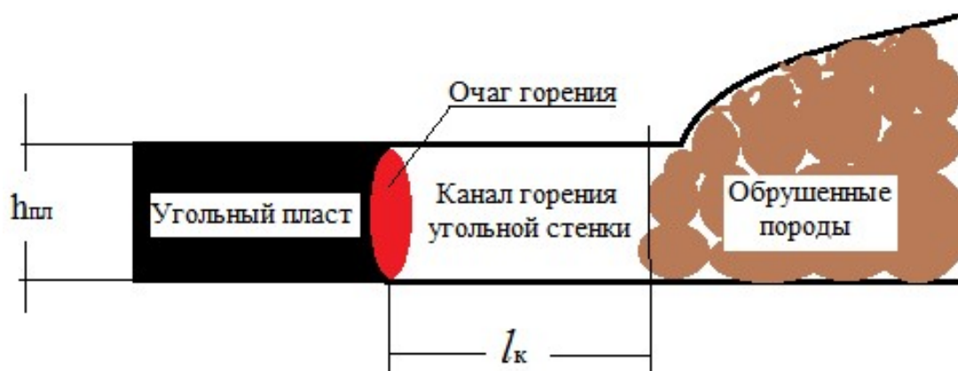
Рисунок 2.6 - Канал горения стенки угольного пласта
