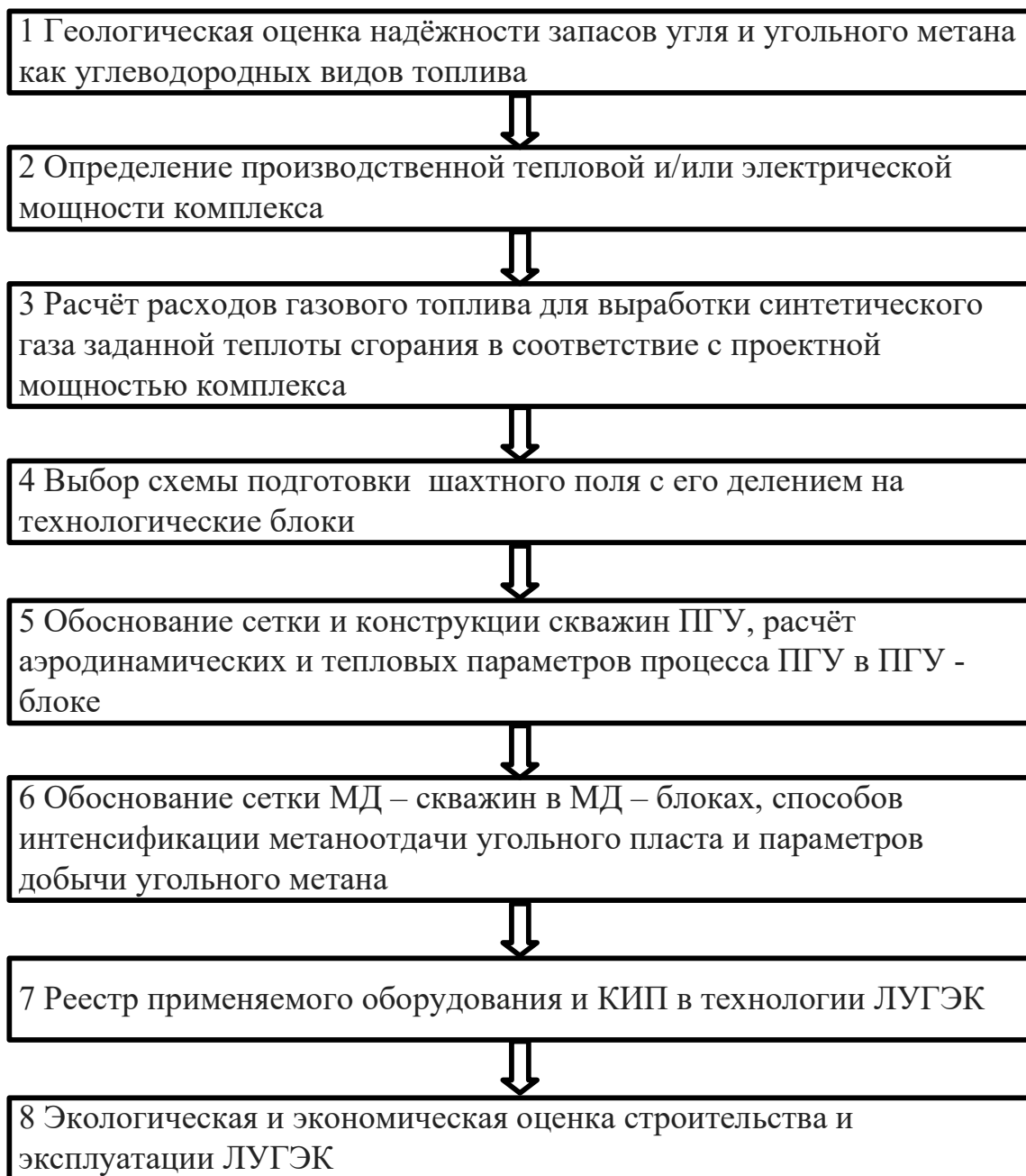
Рисунок 4.3 - Последовательность выполнения проектных решений по расчётам и обоснованию технологической схемы ЛУГЭК на базе ПГУ
