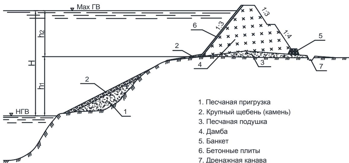
Рисунок 7 - Принципиальная схема берегозащитных сооружений
